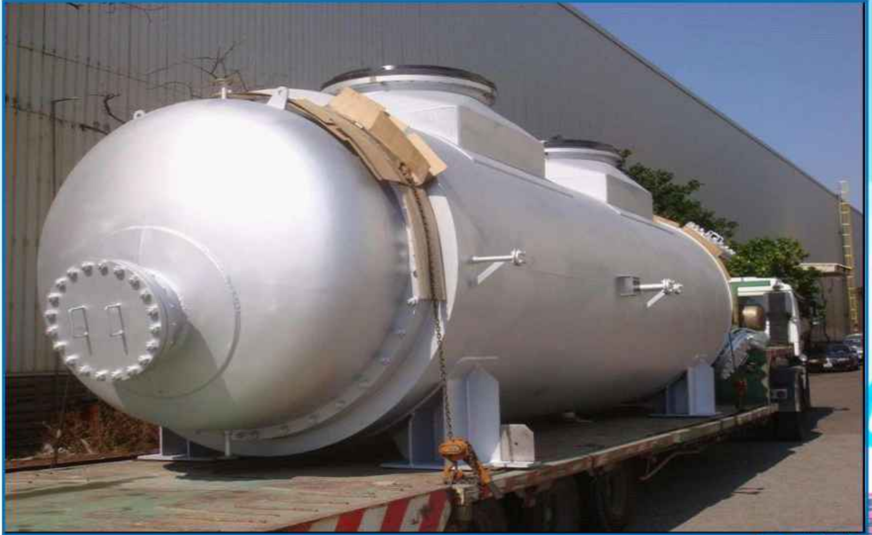
八里垃圾焚化廠 冷凝器
