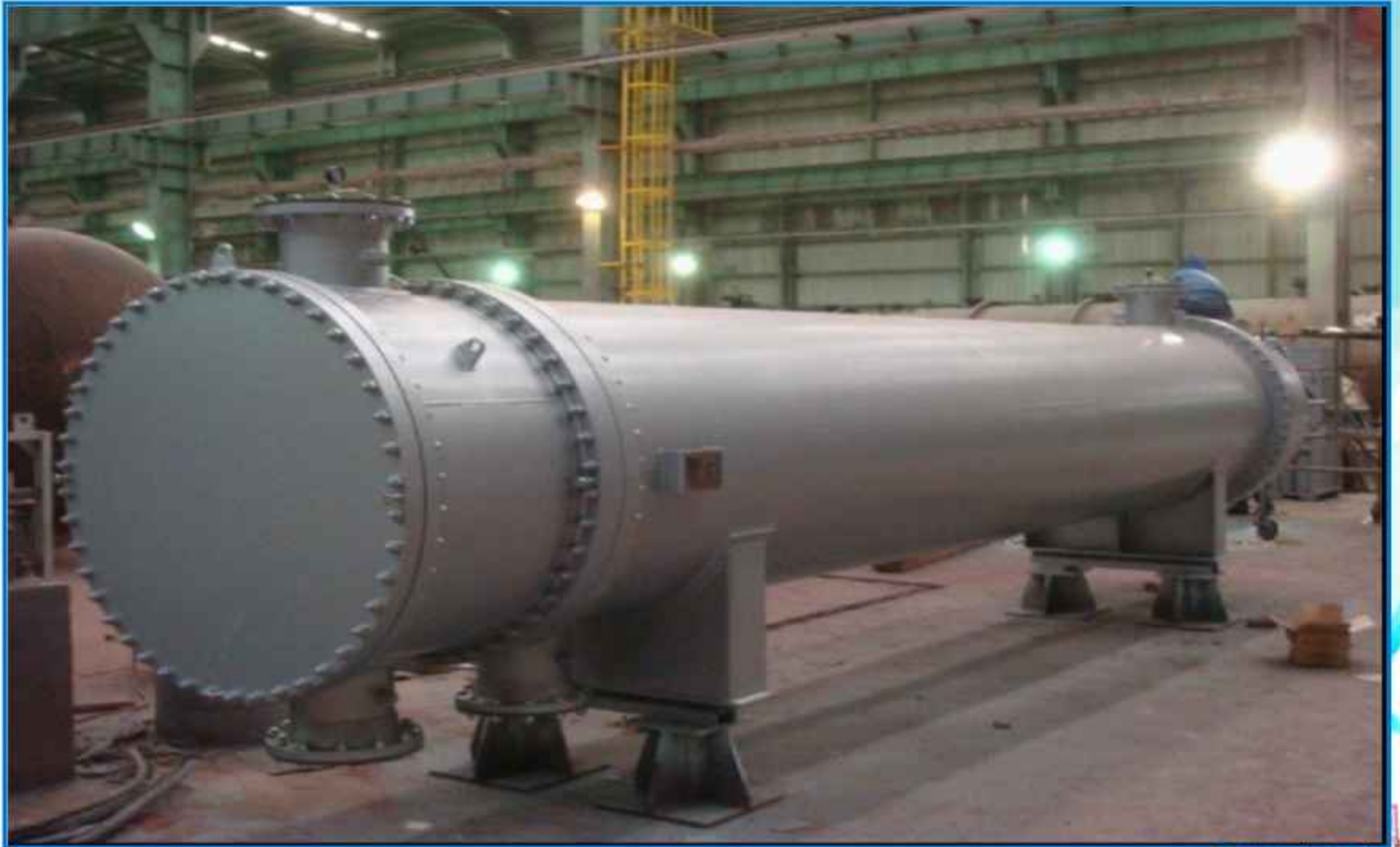
中油/台塑/唐榮/石化廠/製藥等 管殼式熱交換器
